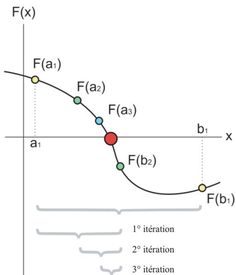
FIGURE 2 – Schéma de l'algorithme de dichotomie
