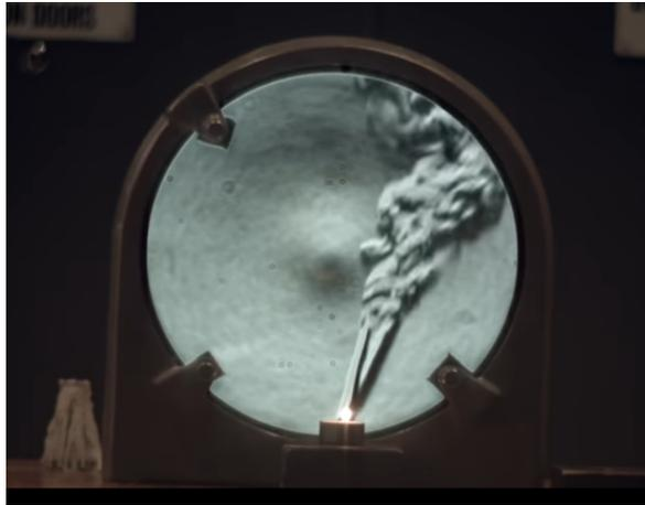
FIGURE 2 – Visualisation de la convection par strioscopie, Harvard Natural Science 2014
