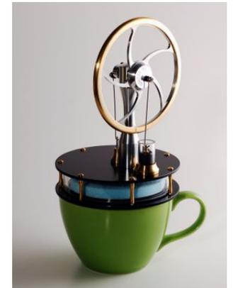
1 - En fonctionnement, le moteur prélève de l'énergie à la source chaude et la relargue à la source froide. La température  $\theta_C$  diminue et le moteur s'arrête lorsque la température de la source chaude est égale à la température de la source froide.
