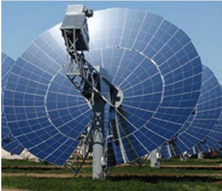
FIGURE 1.7 – Projet Tessera Solar, abandonné en 2010. Production théorique de 850 MW
