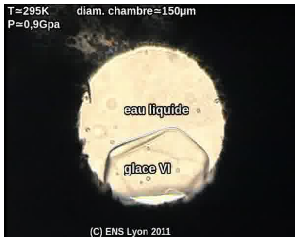
FIGURE 1.5 – Glace VI "qui coule" dans une enclume à diamant.
