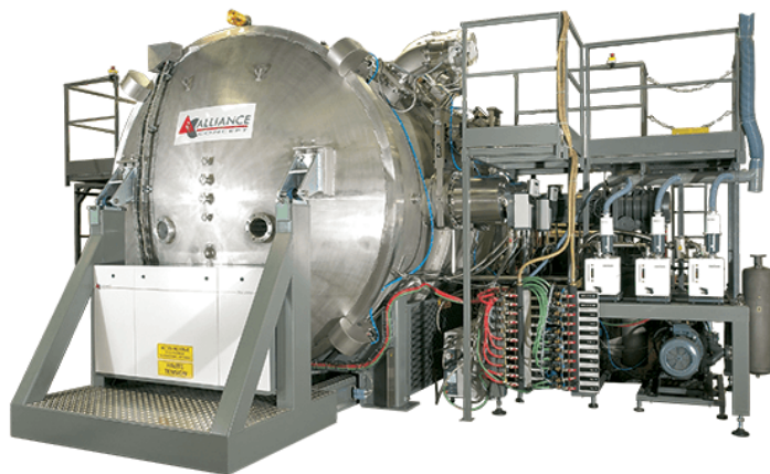
FIGURE 1.9 – Machine de métallisation industrielle. Alliance Concept. D'après www.alliance-concept.com .
