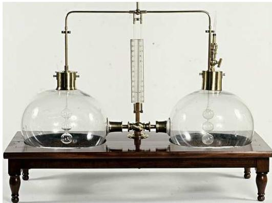
FIGURE 1.3 – Dispositif de détente de type Gay-Lussac. Collection de l'école polytechnique
