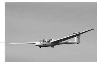
placement dans l'air génère une force se décomposant sous la forme d'une traînée (parallèle au déplacement de l'engin) et d'une portance, perpendiculaire au déplacement. Ces forces s'écrivent respectivement :
