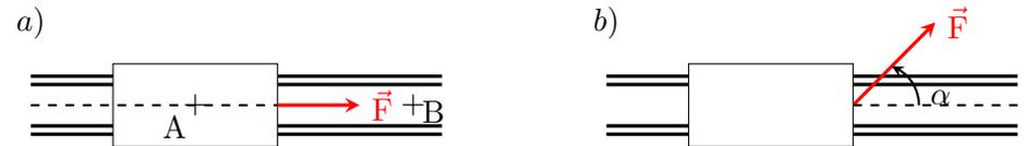
FIGURE 1.1 – Force et déplacement d'un wagon (vue de dessus). Wagon tracté le long des rails a) ou sur le côté b).
