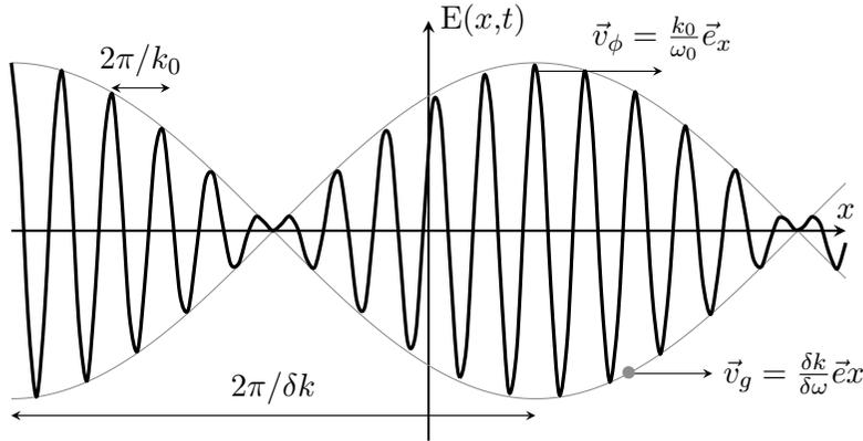
FIGURE 1.6 – Superposition de deux OPPMS de vecteurs d'onde proches, l'enveloppe se déplace à  $\vec{v}_g$  tandis que l'intérieur se déplace à  $\vec{v}_\phi$ .
