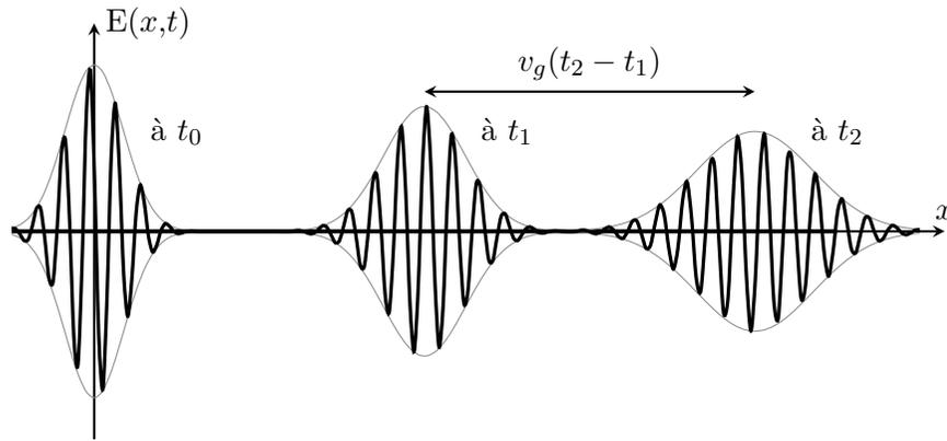
FIGURE 1.10 – Étalement d'un paquet d'onde lors de sa propagation dans un milieu dispersif.
