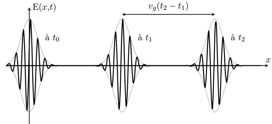
FIGURE 1.8 – Propagation sans déformation d'un paquet d'onde lors de sa propagation dans un milieu **non**-dispersif.
