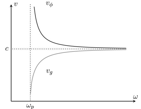
FIGURE 1.9 – Évolution de  $v_\phi$  et  $v_g$  en fonction de la pulsation dans un plasma.
