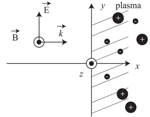
FIGURE 1.4 – OPPM polarisée selon  $\vec{E} \perp \vec{k}$ . Cette onde interagit avec les particules chargées dans le plasma. On suppose que les ions et les électrons sont sources d'un champ électromagnétique.
