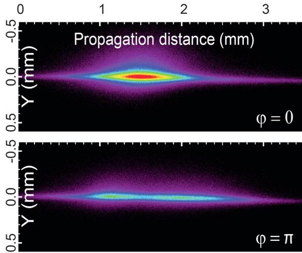
FIGURE 1.3 – Observation de différents régimes de propagation d'un laser dans un plasma. D'après Béjot *et al*, Phys. Rev. A **92**, 053417 (2015). ©(2024) aps.
