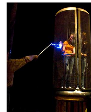
FIGURE 1.11 – Cage de Faraday (palais de la découverte, ©A. Tavenaux,
