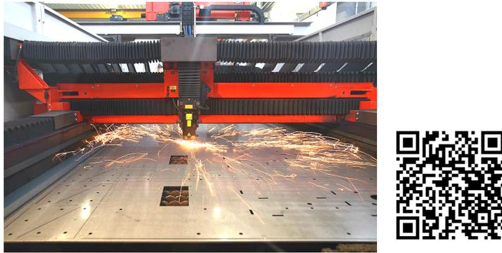
FIGURE 1.13 – Laser de découpe (©), vidéo de Amada LC 3015 X1 NT ©, puissance 4 kW.
