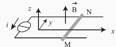
L'action de Laplace s'applique uniformément sur le conducteur, son point d'application est donc au centre géométrique de l'objet. Pour un courant de  $i = 1$  A dans un champ magnétique intense de  $B = 1$  T, la force de Laplace sur un conducteur d'une longueur de  $d = 10$  cm vaut :  $F_{lap} = 0,1$ N. Cette force est très faible, pour obtenir des actions plus importantes, il faut augmenter le courant, soit avec le générateur, soit en augmentant le nombre de spires du circuit.
