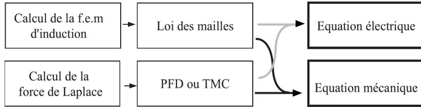
FIGURE 1.3 – Schéma de résolution.
