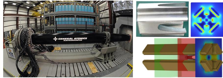
FIGURE 1.4 - (Gauche) Canon électromagnétique de l'US Navy (U.S. Navy photo by John F. Williams, 2012). (Droite) Projectile et simulation du champ magnétique dans des rails quadrupolaires. D'après *Design and Experimental Study of a Curved Contact Quadrupole Railgun, Electronics, 2022*.
