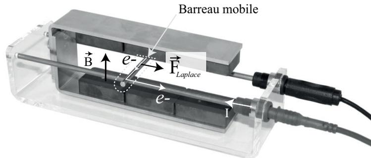
FIGURE 1.2 – Force de Laplace sur un dispositif commercial (Equascience ©).
