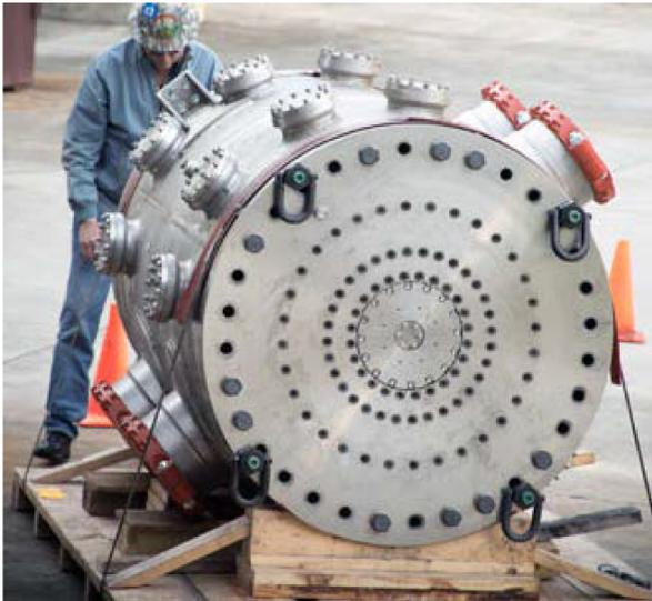
FIGURE 6 – Bobine résistive créant un champ de 41 T au centre de recherche National High Field Laboratory (Floride, Aout 2017). Puissance nécessaire 41 MW. Image courtesy of Tim Murphy, NHL.
