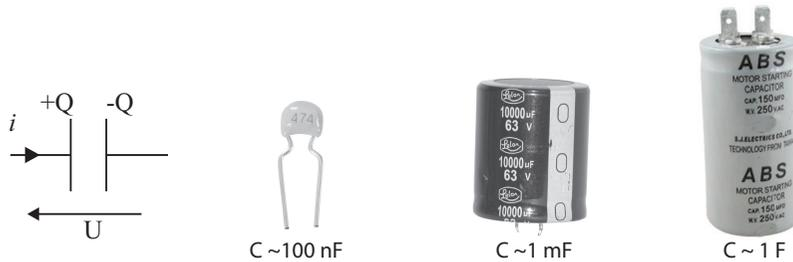
FIGURE 1.3 – Les différents types de condensateur
