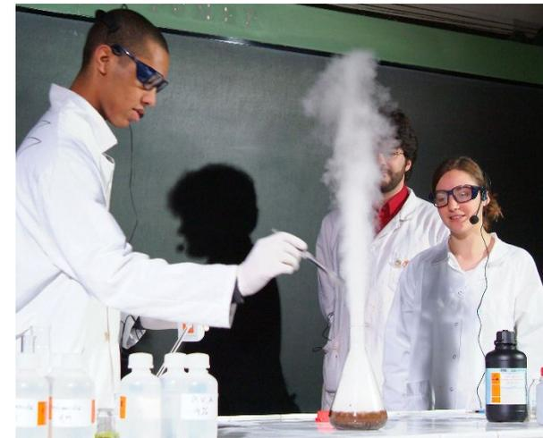
FIGURE 1.1 – Ajout du permanganate de potassium dans l'eau oxygénée. On distingue la phase inférieure incolore (eau oxygénée) et la phase supérieure foncée (permanganate de potassium et dioxyde de manganèse). Le brouillard est constitué de fines gouttelettes d'eau. Crédit photo : O. Got, Université Bordeaux
