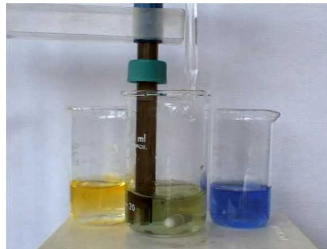
FIGURE 1.2 – Indicateur coloré : bleu de bromothymol  $\text{pK}_a = 7$
