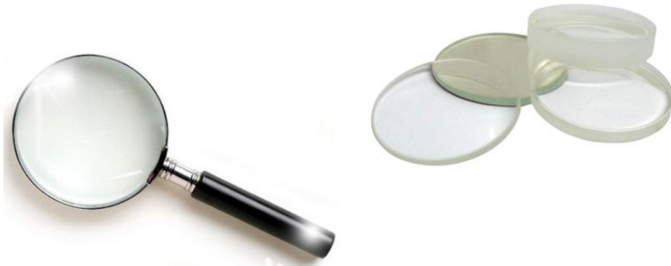
FIGURE 2.1 – Lentille convergente usuelle (loupe) et de travaux pratiques (sodalab)
