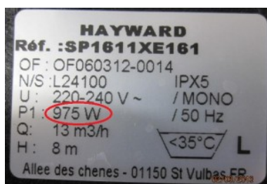
FIGURE 5 – Plaque signalétique d'une pompe
