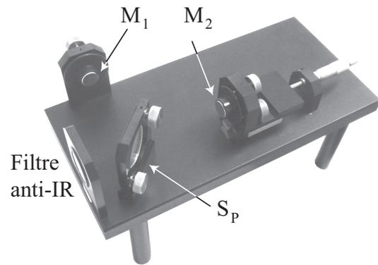
FIGURE 1 – Interféromètre de Michelson pour TP.
