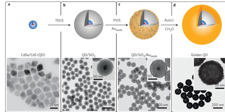
FIGURE 3 – Réalisation de boîte quantique protégée. Nature 2015, Non-blinking quantum dot with a plasmonic nanoshell resonator, Dubertret.
