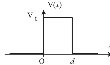
FIGURE 5 – Barrière de potentiel associée à une pointe de microscope électronique à effet tunnel. Vue d'artiste d'après Wikipédia.
