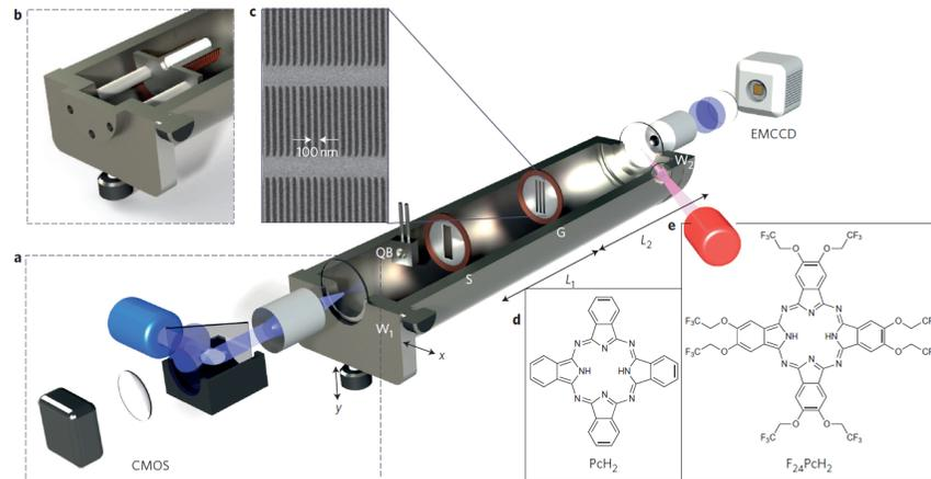
FIGURE 6 – Dispositif expérimental permettant les interférences de molécules (d). (a) évaporateur, (c) réseau de fentes, (e) excitation des molécules déposées sur la quartz par diode laser. (tiré de *real-Time single molecule imaging of quantum interference*, Nature Nanotechnology, Juffmann et al. 2012 )
