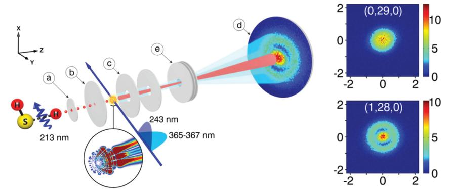
FIGURE 5 – Visualisation de la densité de probabilité électronique pour l'atome d'Hydrogène. Schematic overview of the experiment. (a) atome d'hydrogène issu de la dissociation  $H_2S$  sélectionné par une ouverture de 3mm, (b) et (c) électrodes, (d) détecteur, (e) lentille Einzel (tiré de *Hydrogen Atoms under Magnification : Direct Observation of the Nodal Structure of Stark States*, Stodolna et al., PRL 2013 )
