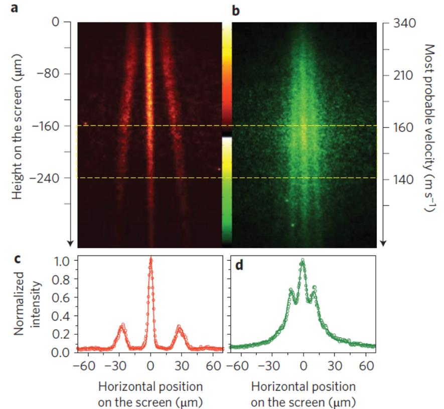
FIGURE 7 – Franges d'interférences des molécules poids atomique 514 et 1028 (tiré de *real-Time single molecule imaging of quantum interference*, Nature Nanotechnology, Juffmann et al. 2012 )
