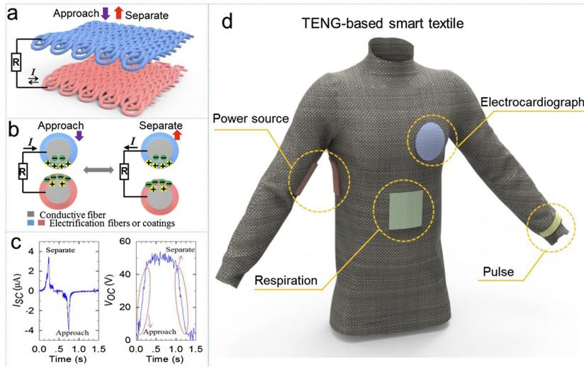
FIGURE 1 – Textile connecté auto-alimenté par triboélectricité. D’après (TENG - Triboelectric nanogenerator, Wang, Rep. Prog. Phys. **84**, 096502 (2021)).
