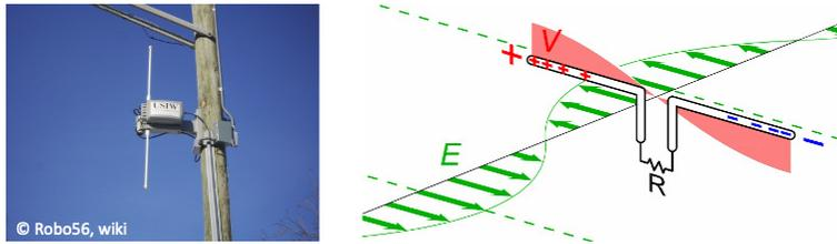
FIGURE 1 – Antenne dipolaire (©) et champ électrique rayonné.
