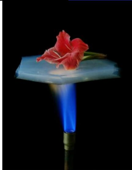
**Figure** – Projet NANOCEL, les premiers superisolants thermiques biosourcés. La cellulose et ses dérivées sont utilisés pour améliorer les propriétés des silices superisolantes de conductivités inférieures à  $0.015 \text{ W/m.K}$ . (juin 2013)
