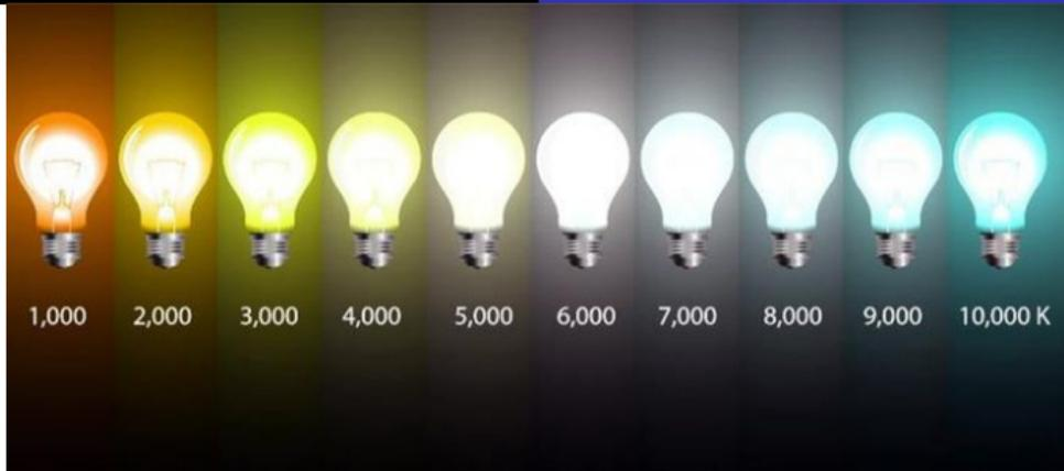
Figure – Aspect des ampoules éclairées en fonction de la température de référence.
