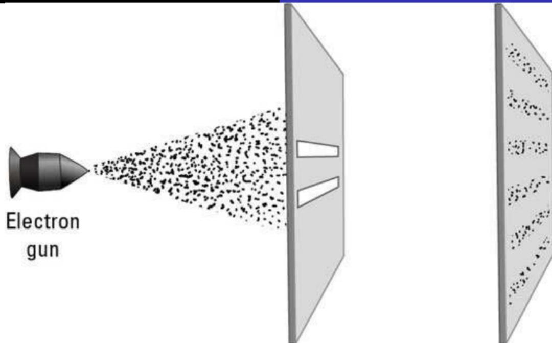
Figure – Principe de l'expérience des fentes d'Young avec des électrons.
