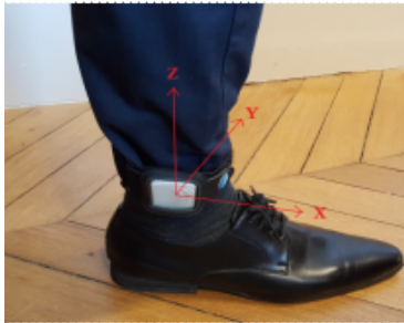
Figure – Reconstruction du mouvement d'un marcheur à l'aide d'un accéléromètre, d'après Robust Stride Detector from Ankle-Mounted Inertial Sensors for Pedestrian Navigation and Activity Recognition with Machine Learning Approaches , Sensors , 2019, sous licence Creative Commons 4.0.
