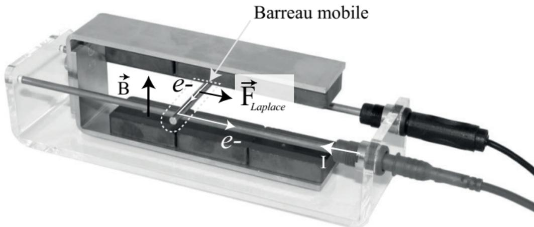
Figure – Force de Laplace sur un dispositif commercial (Equascience ©).
