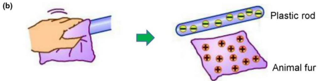
**Figure** – Charge par friction. a) A l'intérieur du nuage d'orage, les courants ascendants (air chaud) et descendants (air froid) font s'entrechoquer les particules d'eau et de glace. Ces frictions finissent par électriser le nuage. b) Friction d'une fourrure sur une baguette plastique. D'après *On the origin of contact-electrification*; Wang, *Materials Today* **30**, 34 (2019).
