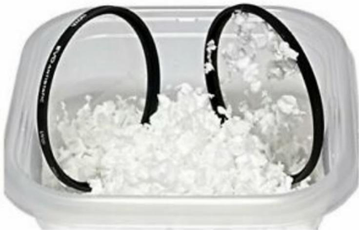
Figure – Dépôt conducteur sur le verre de gauche évitant l'adhésion de billes de polystyrène.
