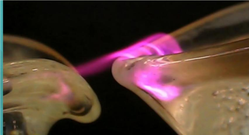
**Figure** – L'état plasma parmi les différents états usuels. Cliché, obtenu par une différence de potentiel de 4 kV entre deux béciers remplis d'eau. Cliché de A. Breuille, Y. Cardot, T. De Warren et A. Relave, Olympiades de physiques 2023.
