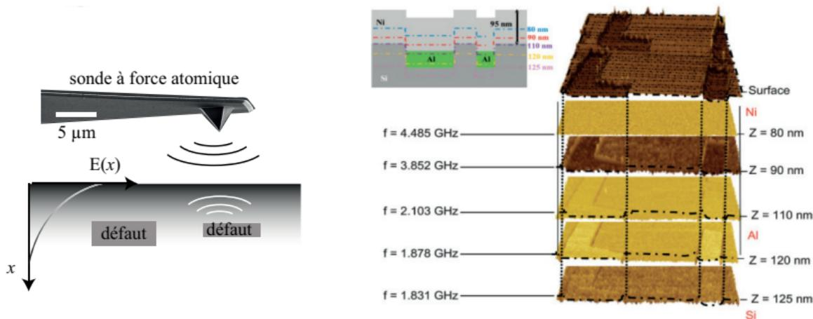
Figure – Sonde à force atomique pour l'étude d'un matériau selon la profondeur. D'après Plassard *et al*, Phys. Rev. B **83**, 121409(R) (2011).
