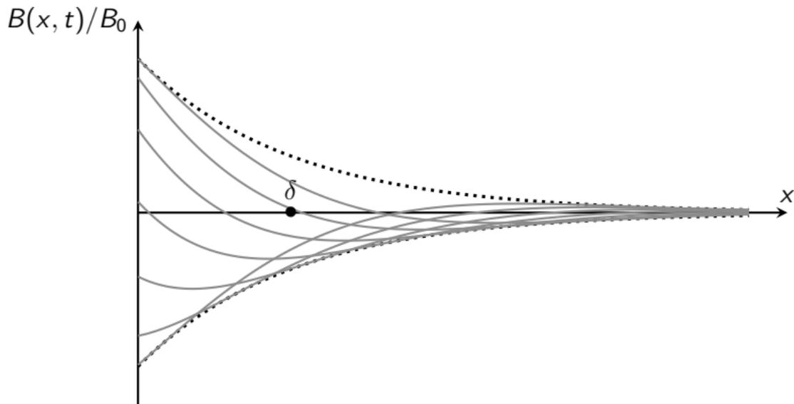
Figure – Atténuation d'une onde électromagnétique dans un métal : effet de peau.
