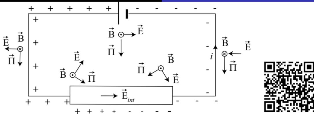
**Figure** – Equivalence entre les approches composants et électromagnétisme dans un circuit électrique. Inspiré de Davis, Kaplan, *Poynting vector flow in a circular circuit*, Am. J. Phys. **79**, 1155 (2011). QR code, *Que se passe-t-il (vraiment) dans les fils électriques?* D. Loupre.
