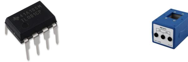
FIGURE 1 – ALI et bobine de détection (600 spires).
