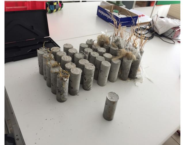
Eprouvette de béton (5 par type)
