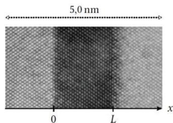
FIGURE 1 – Image au microscope électronique de la partie active d'une diode laser
