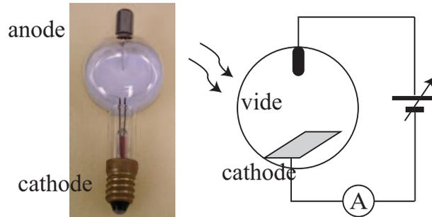
On éclaire la cathode de la cellule avec une radiation monochromatique de longueur d'onde  $\lambda$  dans le vide. G est branchée de telle manière que le courant dans A est nul lorsque la tension aux bornes de G est supérieure à une certaine tension  $U_s$ .
