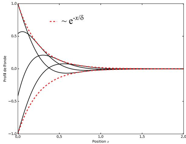
FIGURE 2 – Onde électromagnétique dans un métal : effet de peau.
