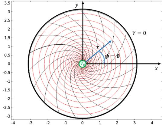
FIGURE 1 – Simulation Comsol de l'effet Hall en géométrie Corbino. Lignes de courant. D'après *Etude des effets magneto-transverses dans les matériaux ferromagnétiques : effets Righi-Leduc planaire et anomal et géométrie Corbino*. Thèse B. Madon. 2017.
