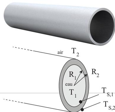
face extérieure et on considère que la température au sein du matériau ne dépend que de la distance  $r$  par rapport à l'axe du tube. On néglige les effets de bord (comme si le tube était infiniment long selon l'axe des  $z$ ) et on raisonne sur une longueur  $L = 10 \text{ m}$  de ce tube. On cherche à déterminer la puissance perdue en régime permanent.
