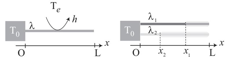
circulaire de rayon  $R = 1$  cm, de longueur  $L$ , de conductivité thermique  $\lambda_1$ . On le met en contact par une de ses extrémités  $x = 0$  avec de l'eau bouillante de température  $T_0 = 373$  K. La température extérieure est  $T_{ext} = 293$  K.
