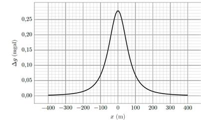
*Présence de cavités enterrées.. Anomalie gravimétrique  $\Delta g$  pour une sphère enterrée avec  $\Delta\mu = 1000 \text{ kg} \cdot \text{m}^{-3}$*
