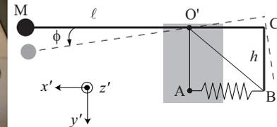
1 - Déterminer la distance  $L = AB$  en fonction de  $\phi$ ,  $h$  et  $L_1$ .
