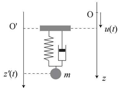
FIGURE 1 – Sismomètre.
