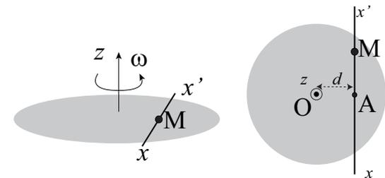
plateau à une distance  $d$  de l'axe  $Oz$ . Ce point est soumis à son poids, à la réaction du support et à une force de rappel  $\vec{F} = -k \cdot \vec{AM}$  où  $A$  est le projeté orthogonale de  $O$  sur les rail. On notera  $AM = x$ .
