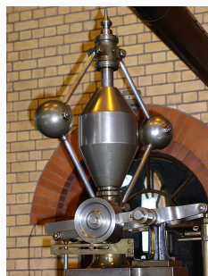
FIGURE 1 – Régulateur de Watt d'une machine Ashton Frost, cliché réalisé par Globbet, sous licence Creative Commons 4.0 .
