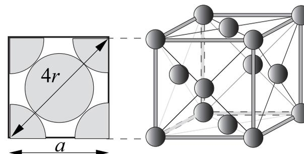
FIGURE 6 – Condition de contact sur la maille cubique faces centrées
