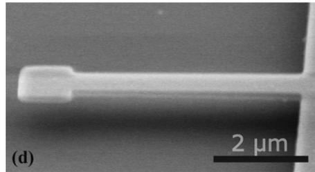
FIGURE 3 – Nano poutre vibrante pour la détection de virus d'après *Virus detection using nanoelectromechanical devices, App. Phys. Lett. 2004*
