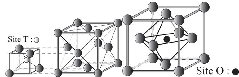
4 - La condition de contact pour les sites tétraédriques s'écrit sur la diagonale du cube de côté  $a/2$  :  $2(r + r_T) = a\sqrt{3}/2$
