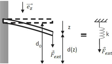
FIGURE 1 – Système encastré dans une paroi et modèle.
