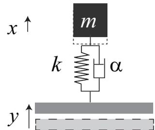
FIGURE 4 – Système excité par la base
