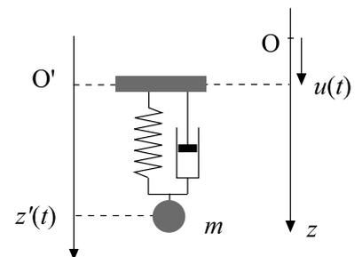
FIGURE 3 – Sismomètre.
