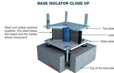
FIGURE 1 – Friction Base insulator : système parasismique (d'après <https://www.readymadeseminar.com/2015/06/base-isolation.html>)
