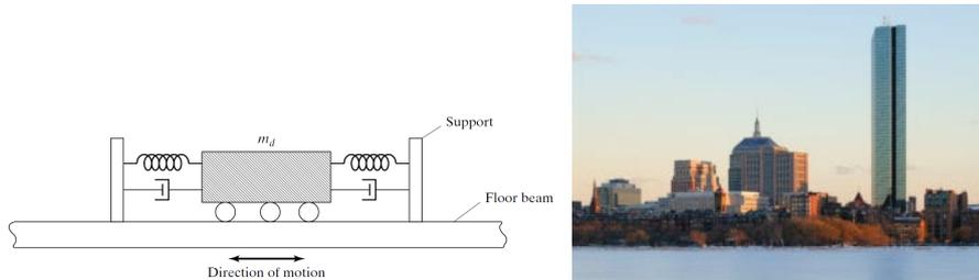
FIGURE 2 – Système d'amortissement de la tour Hancock
