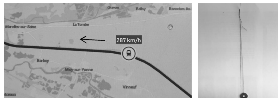
FIGURE 3 – La carte permet d'estimer que le rayon de courbure du virage lors de la réalisation de l'expérience est R_C = 4 km. Sur la photo à droite, le segment noir matérialise la verticale lorsque le train est à l'horizontale.
